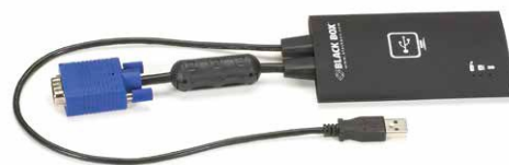
Adaptador de emergencia para ordenadores portátiles (KVT100A-FT)
